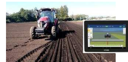
自動操舵補助システム (直進性をGPSで補正)
