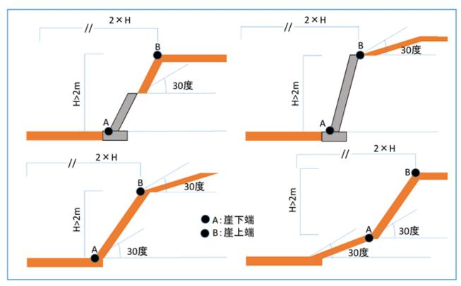
上下に分断された崖は、以下のとおり30度の角度をなす面を基準として一体かどうかを判断します。
