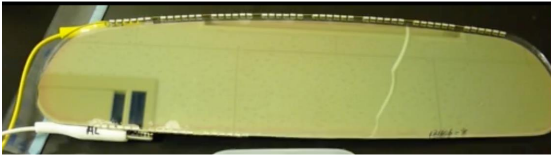
電流を流し着色させ眩しさを抑える
